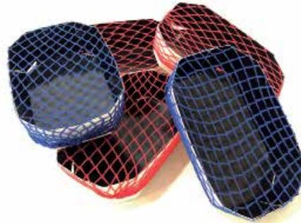
Estas mallas están fabricadas con la primera poliamida capaz de degradarse por acción biológica. De hecho, hace sólo un año que empezaron a fabricarse. Con apenas medio gramo de material es posible envasar hasta un kilo de fruta. Además, se pueden fabricar de diferentes dimensiones para utilizarse con todos los modelos de envases existentes en el
