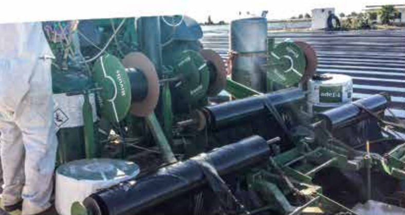
Desinfección localizada al efectuar los lomos de cultivo
