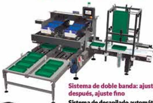
Sistema de doble banda: ajuste grueso, y después, ajuste fino
